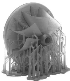
Рисунок 4.20 – Пример 3D-объекта с сформированной поддержкой
