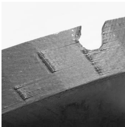
Рисунок 4.27 – Наплывы материала, вызванные неправильным расчетом скорости движения сопла в слайсере [63]
