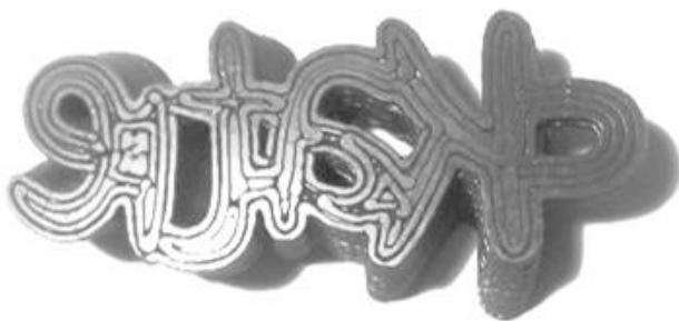
Рисунок 4.23 – Пример дефекта в виде щели между нитями первого слоя [63]
