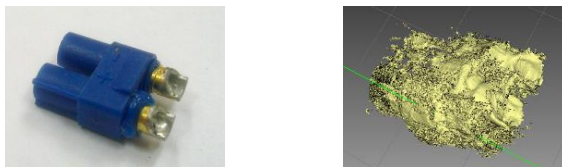
Рисунок 4.7 – Невозможность получения цифрового скана из-за особенностей сканированной поверхности
