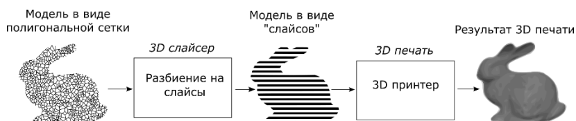
Рисунок 4.17 – Иллюстрация работы слайсера [61]
