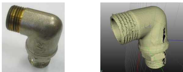
Рисунок 4.12 – Дефекты поверхности вызванные световыми бликами. Слева – фотография объекта, справа – визуализация цифрового скана
