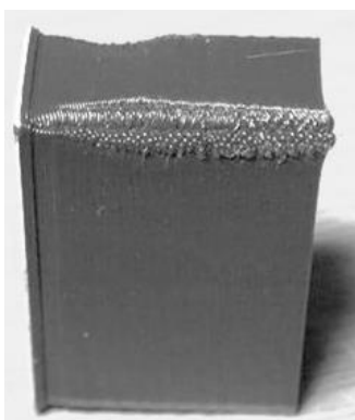
Рисунок 4.22 – Пример 3D-печати с температурным дефектом [63]
