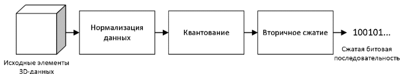
Рисунок 2.6 – Последовательность этапов при сжатии с потерями томографических данных
