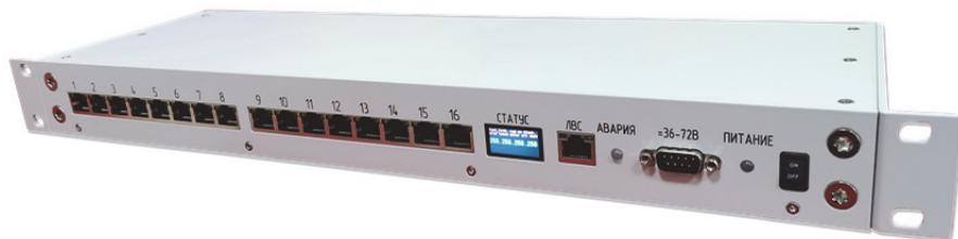
Рис. 1. Шлюз Ethernet-RS232/485-x16
