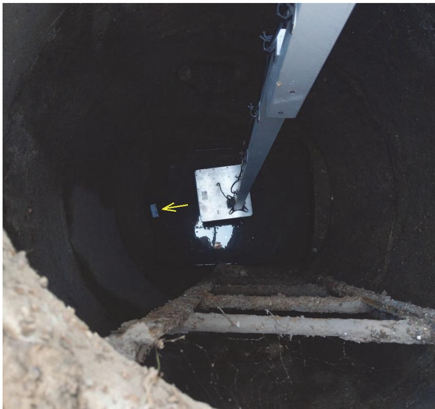
Рис. 3. Регистрация датчика с меткой RFID в контрольном люке ливневой канализации
