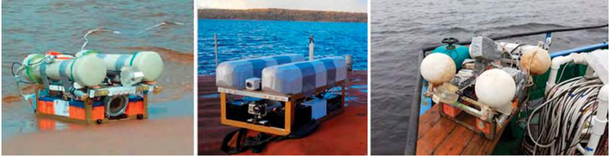
Рис. 5.1. Телеуправляемый необитаемый подводный аппарат Limnoscout-230 в различных модификациях 2018–2020 гг.
